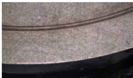
Ranura de asentamiento después de 24 horas
