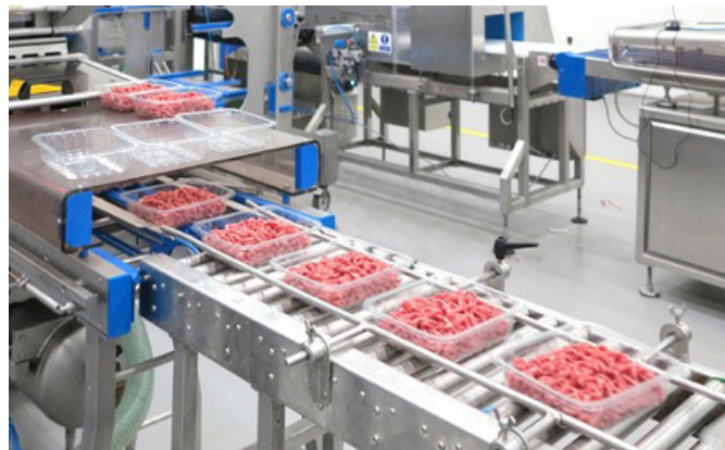
Línea transportadora de llenado de carne
