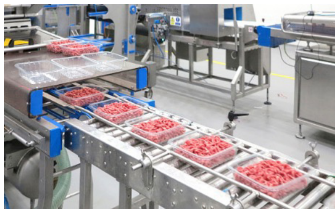
Línea transportadora de llenado de carne
