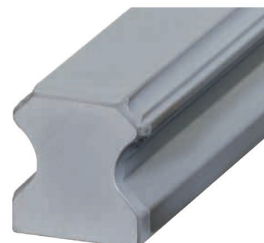
Guía (sin carga) con recubrimiento CTS: después de 22 horas de prueba de pulverización de sal (según DIN EN ISO 9227)
