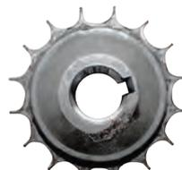
Posteriormente, se debe examinar el piñón para determinar si los dientes están demasiado desgastados. En caso de desgaste excesivo o dientes con forma de gancho, los piñones deben reemplazarse por nuevos.
